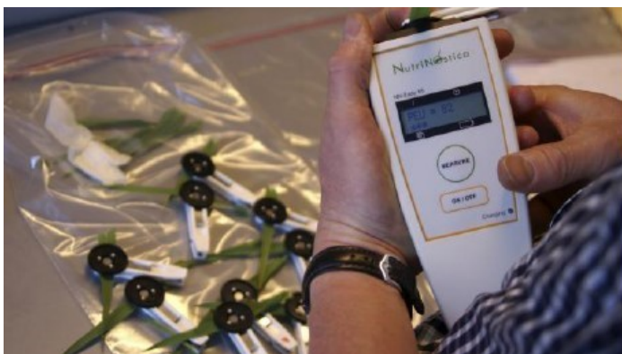
Figur 3. Bladene har været mørklagt i 25 min før mangantesteren (NN Easy 55) anvendes.
